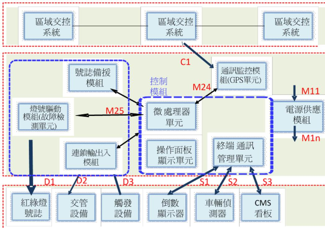
圖 3-1 交通號誌控制器模組介面架構
