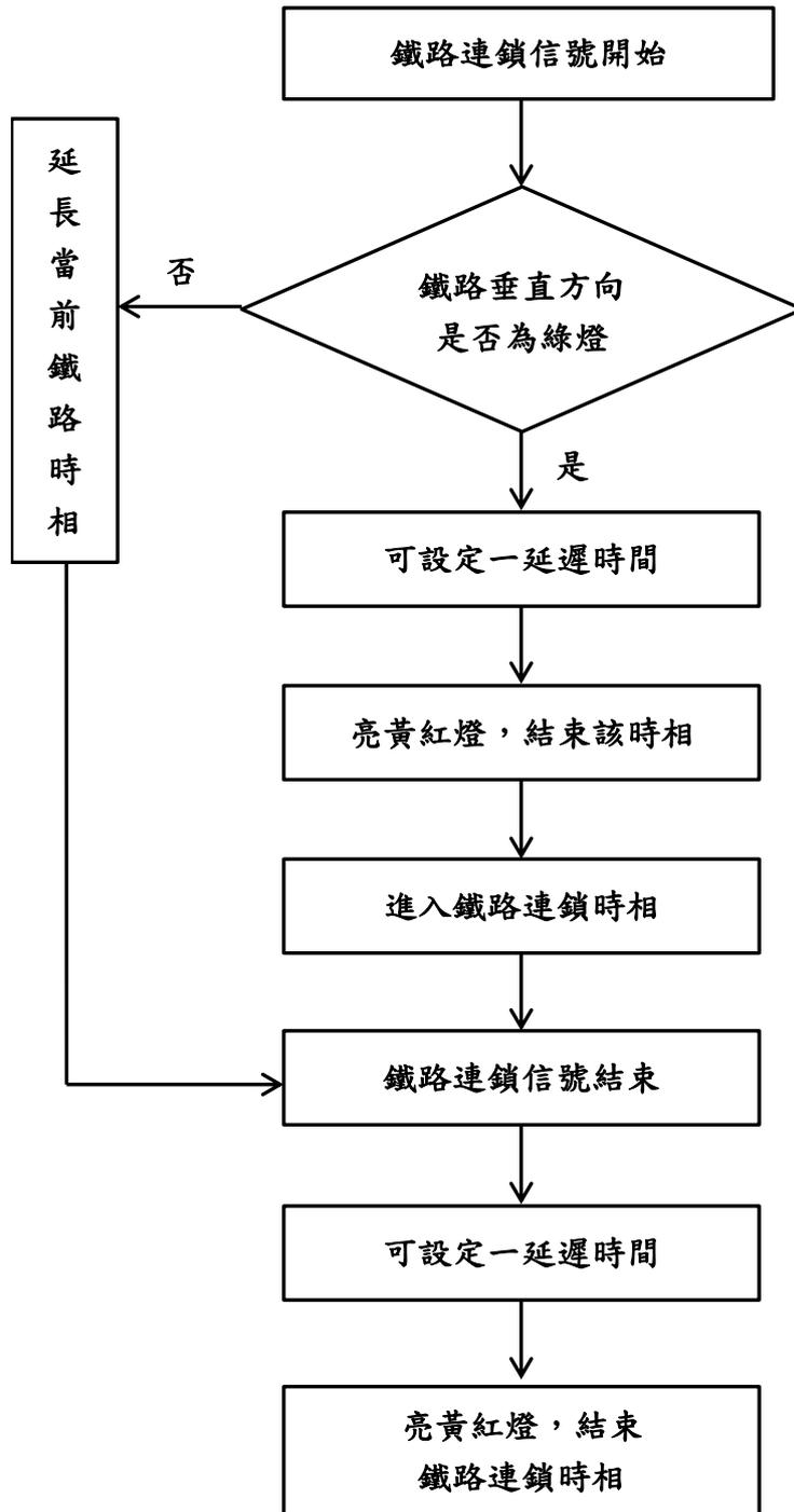
圖 5-1 鐵路觸動號誌控制流程
