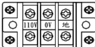
圖 3-11 AC 電源輸入介接端子配置參考
