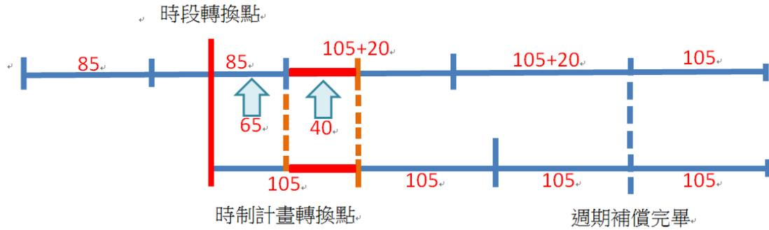
在下達轉換命令後，於兩週期內補償完畢，並將補償的週期時間依照時相的時比平均分配給各時相使用。
