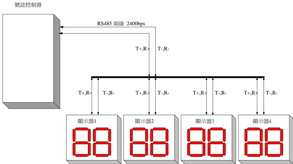
圖 4-1 紅燈倒數計秒顯示器連線模式架構
