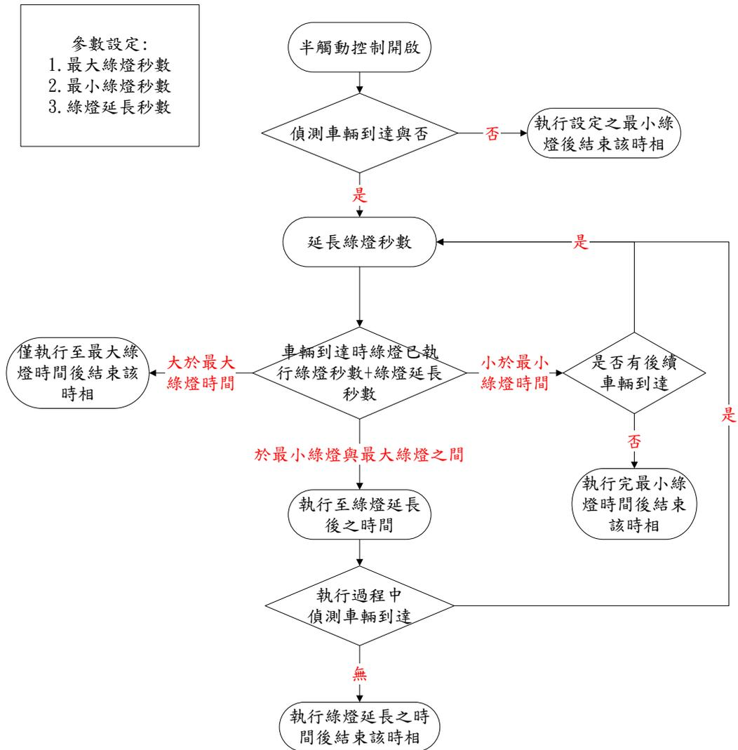
圖 5-2 全(半)觸動號誌控制流程
