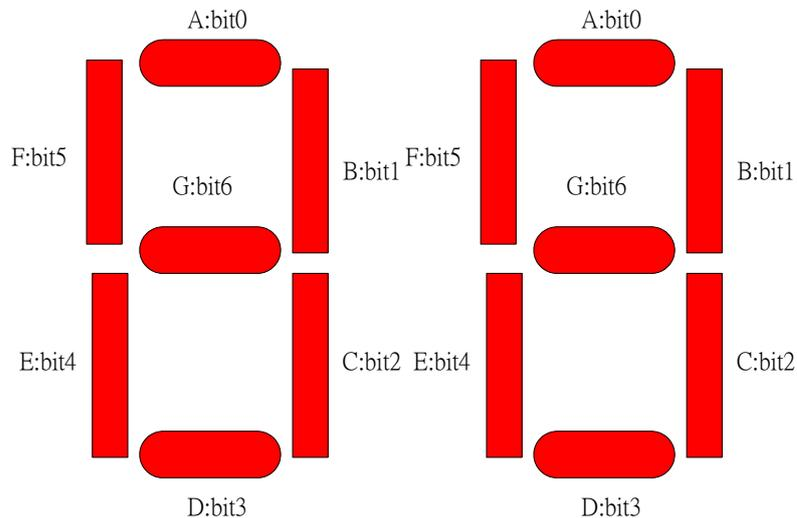
圖 4-2 倒數計數顯示器之七段顯示驅動位元定義
