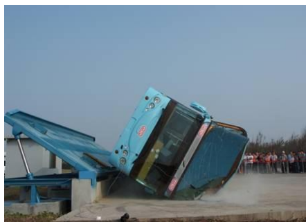
整車翻覆結構測試
