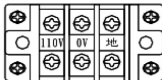
圖 3-12 AC 電源輸入介接端子配置參考
